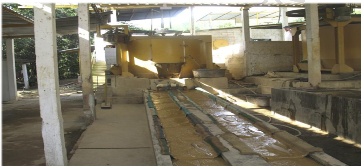
Figura 9 Molino chileno con canaletas cubiertas con alfombras de lana para concentrar oro y técnica de extracción de oro (Ecuador). Fuente: (Veiga. M, 2014)
