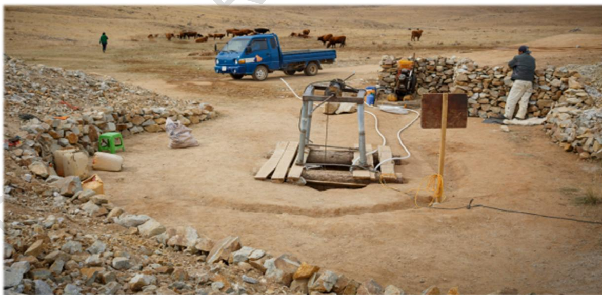
Figura 11 Torno de extracción manual. Fuente: (WGC, 2025).
