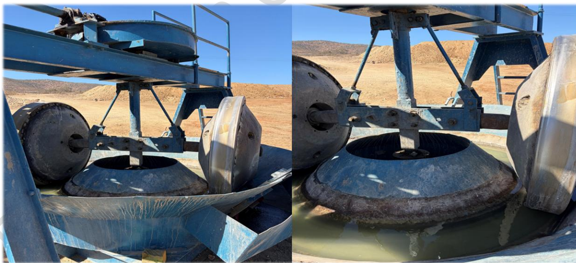
Figura 8 Trapiche utilizado en planta de procesamiento de oro. Fuente: SONAMI
