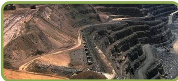
**(3) Extracción:** esta etapa contempla la perforación de la superficie para la instalación de explosivos, la ejecución de tronaduras para romper la roca, y el carguío y transporte de mineral hacia las plantas de chancado. La extracción puede ser a rajo abierto o a través de minas subterráneas, lo que dependerá de qué tan espesa sea la capa de estéril
