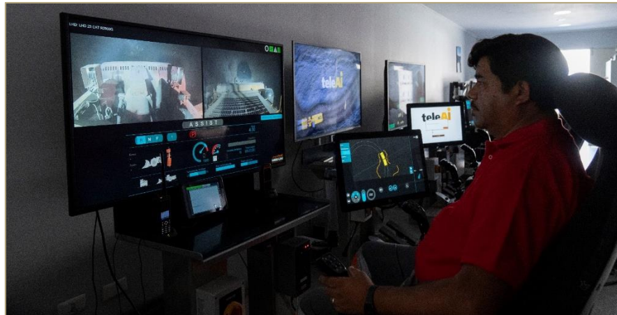
Control remoto y autónomo de equipos LHD's
