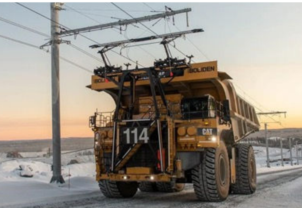
Camión de transporte minero con pantógrafo de Boliden, miembro de la ICA.
