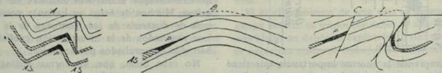
Fig. 2.—Perfiles por anticlinales petrolíferos. P=petróleo; A-S=agua salada.
