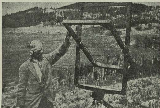
Marco con bobina detectora empleado en la Prospección Geofísica de yacimientos de minerales por métodos eléctricos.
