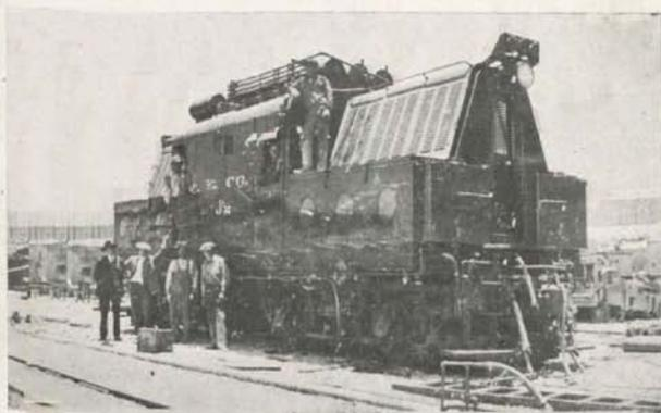
Mineral de Chuquicamata.—Chile Exploration Co.—Tipo de locomotora eléctrica Westinghouse de 70 ton. que trabaja en combinación de acumuladores y tercer riel.
