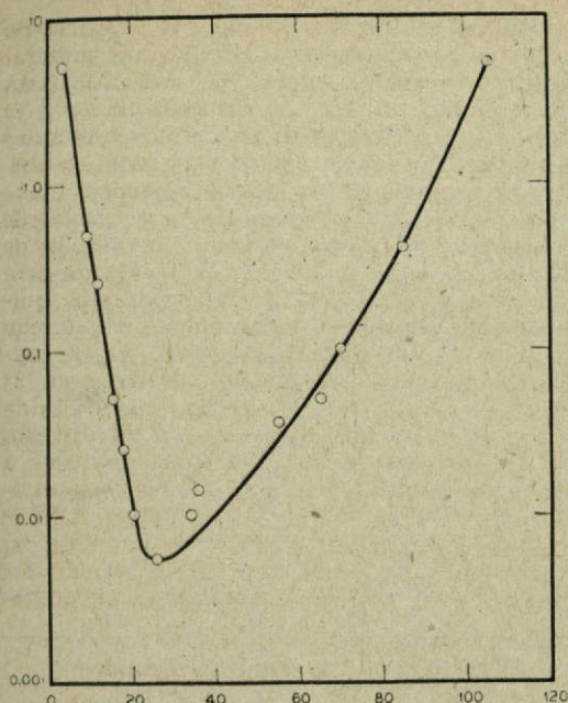
Fig. 4.— Tiempos Glembotsky de adherencia de la burbuja a la galena como una función del contacto mineral-agua, siendo el agua desoxigenada primero y en seguida oxigenada.
