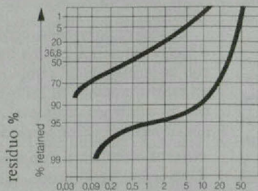
Figura 2.— Distribución granulométrica de una muestra de clínker antes y después de su tratamiento en molino de cilindros de alta presión.
