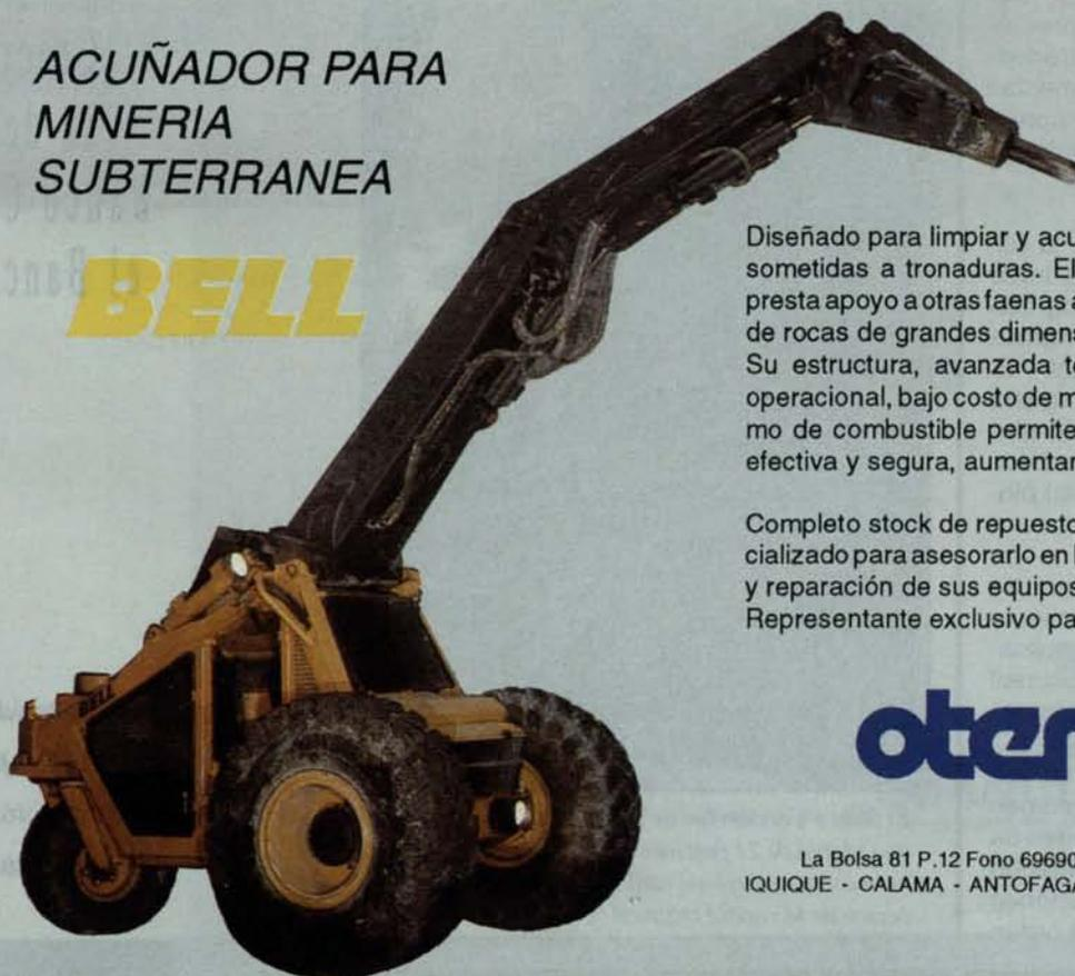
Diseñado para limpiar y acuñar eficientemente zonas sometidas a tronaduras. El acuñador BELL también presta apoyo a otras faenas actuando como demolidor de rocas de grandes dimensiones.
