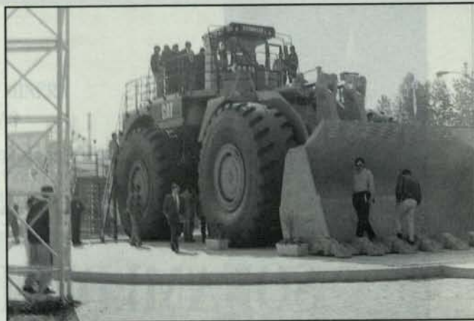
Entre las novedades de Expomin '94 destacó el cargador frontal de tracción mecánica más grande del mundo, cuya altura alcanza los 11 metros. Es el modelo Cat 994 de Caterpillar, que tiene un peso cercano a los 200 toneladas.
