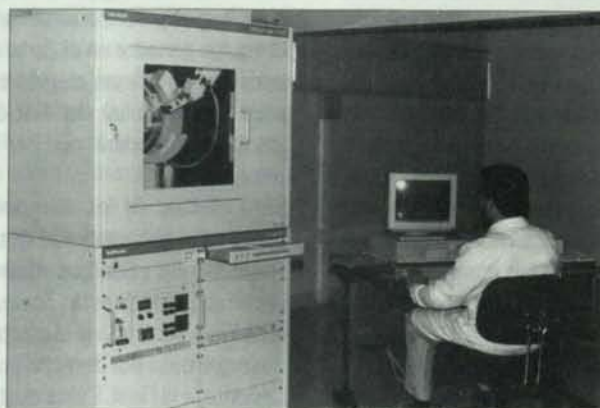
Este es el moderno Difractómetro Siemens D-5000 del Laboratorio Geoquímico de la UC del Norte.
