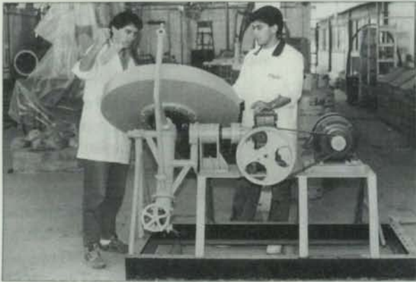
Dos funcionarios trabajan en el plato pelletizador del Departamento de Metalurgia.
