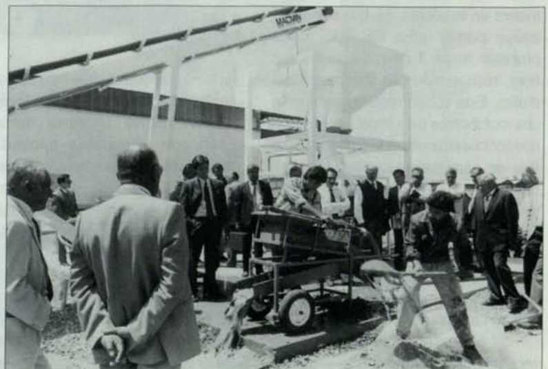
El Prospector convierte a un pequeño lavador de placeres en un empresario. Es un equipo portátil y sólo pesa 85 kilos.
