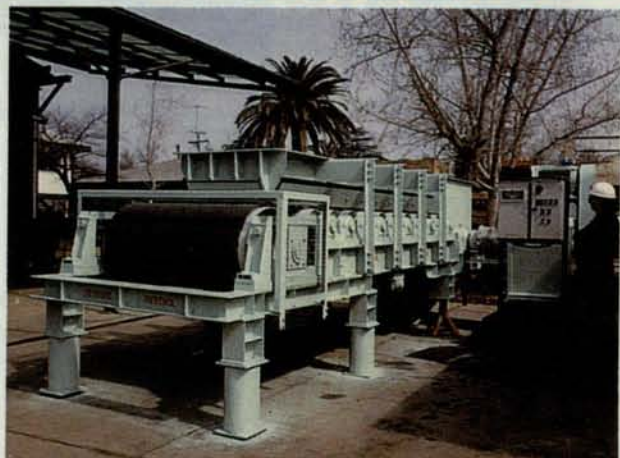
ALIMENTADOR DE CINTA, CAPACIDAD NOMINAL 350 TMPH.
