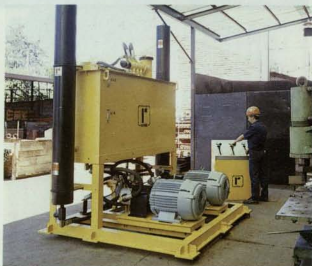
CENTRAL HIDRAULICA CON ACUMULADORES DE PISTON 180 HP.
