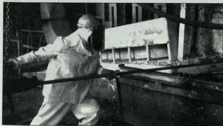
Alimentación de horno reverbero en Fundición Chagres
