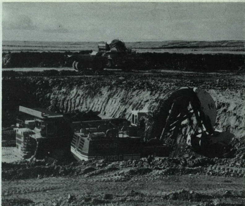
Faenas en la nueva mina a cielo abierto de COCAR Pecket. Las palas hidráulicas cargan camiones de volteo de 120 toneladas. Maquinaria de estas dimensiones se verán en Expomin'90 USA.
