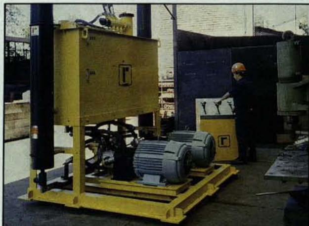
OLEOHIDRAULICA - NEUMATICA CENTRAL HIDRAULICA CON ACUMULADORES DE PISTON 180 HP
