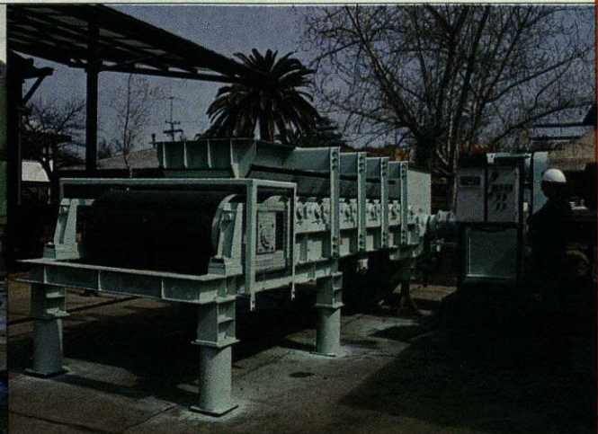
ALIMENTADOR DE CINTA CAPACIDAD NOMINAL 350 TMPH
