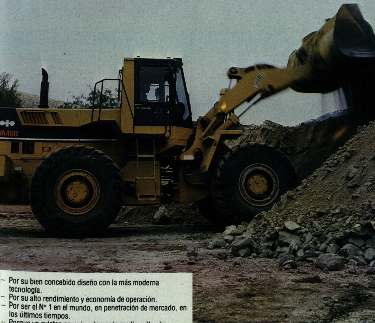
WA400-1 cargando mineral de cobre en faena de CEMIN-CHILE.
