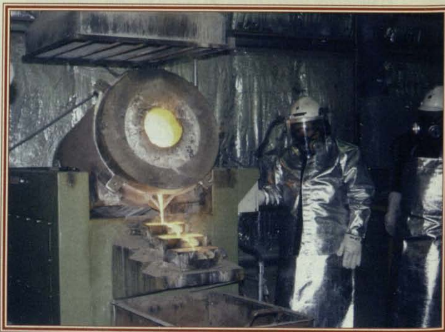
En la actualidad, se hace una fundición diaria que significa producir unas 700 a 800 onzas de oro fino cada 24 horas, contenidas entre una y dos barras de metal doré, cada una de las cuales pesa 20 kilos aproximadamente, que poseen un 90 por ciento a 94 por ciento de oro.
