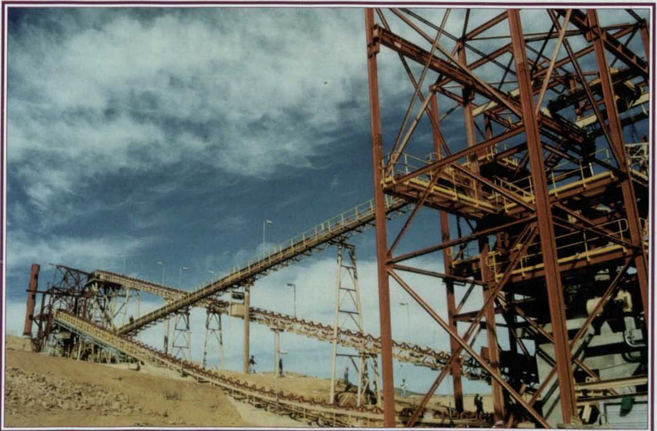
El proceso global considera tres etapas de chancado y clasificación, lixiviación sulfúrica y recuperación metalúrgica del 87 por ciento. El producto final serán cátodos de cobre LME grado A, con una ley estimada de 99,99 por ciento de cobre.
