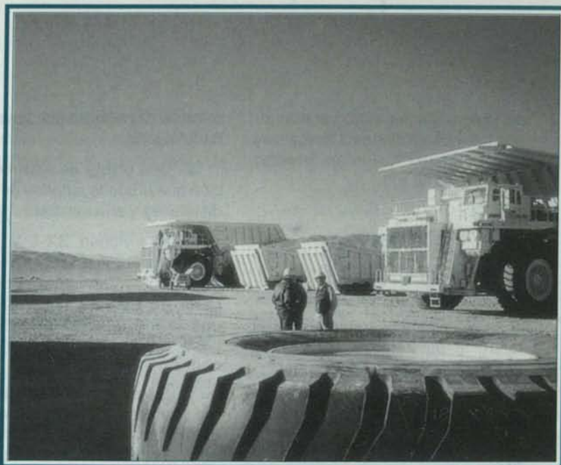
Camiones gigantes de transporte, de 218 toneladas métricas, son parte de la flota inicial de Zaldívar, con 16 unidades.
