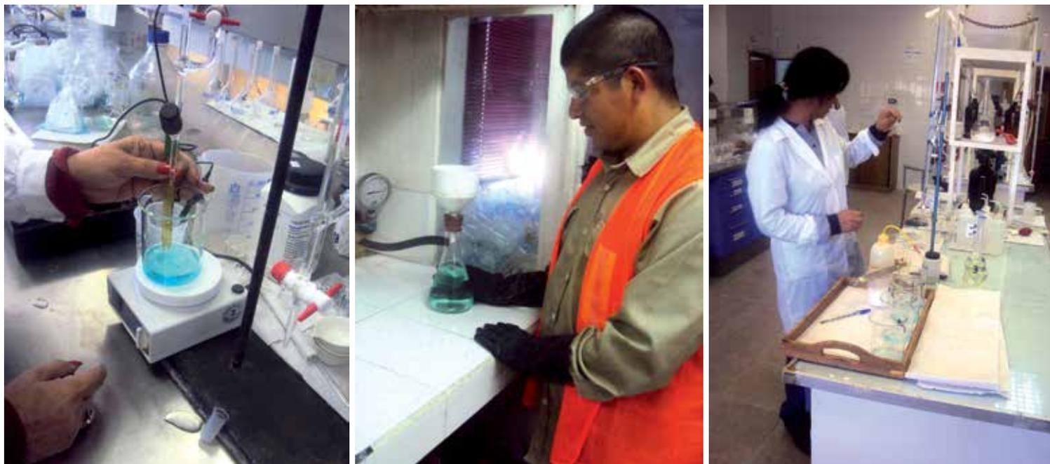
LAS PRUEBAS DE ELECTROOBTENCIÓN SE REALIZARON CON SOLUCIONES DE LIXIVIACIÓN PURIFICADAS PREVIAMENTE CON UNA ETAPA DE EXTRACCIÓN POR SOLVENTES, CON LO CUAL SE OBTUVO CONCENTRACIONES EN TORNO A 40 GR/L DE COBRE.
