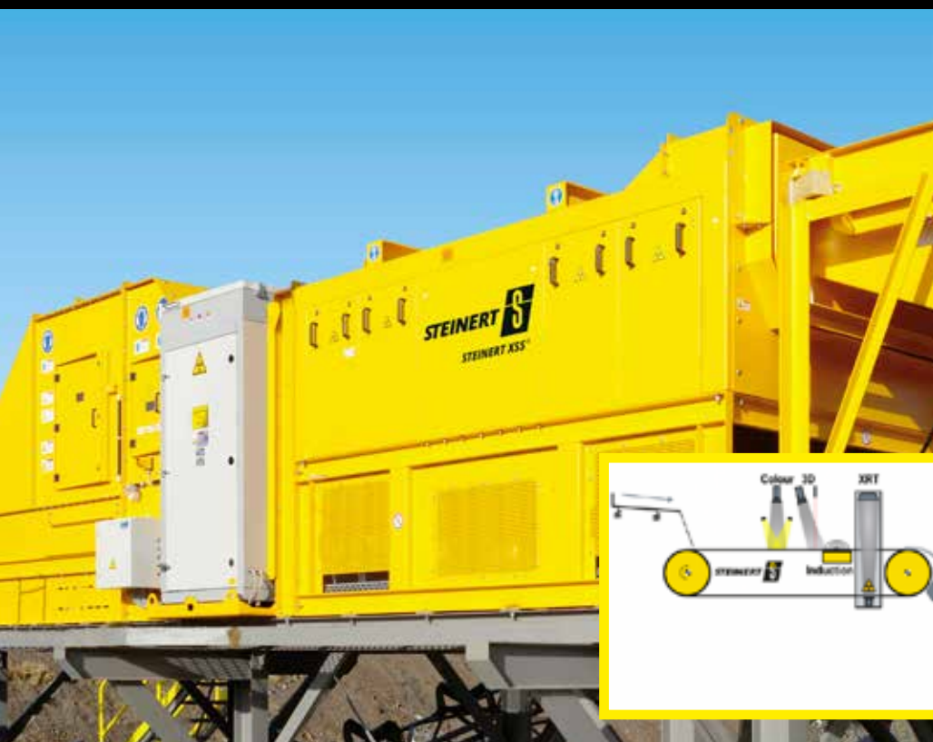
Izquierda: Equipo Ore Sorting. Derecha: esquema conceptual equipo ore sorting en minería: alimentador vibratorio, sensores, procesamiento de datos y eyector de aire producto/descarte.
