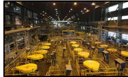
Planta de flotación
