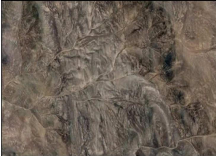
**Fotografías Aéreas:** permiten trabajar en áreas más pequeñas. Con la utilización de pares estereográficos se puede analizar la topografía, redes de drenaje y alineaciones como fallas, fracturas, contactos, etc.
