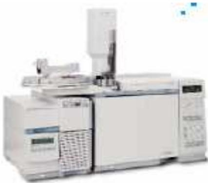
**Cromatógrafo de Gases:** permite analizar sedimentos, rocas y tejidos animales, y otras especies de elementos de importancia en estudios medioambientales (Agua, Riles y otros).
