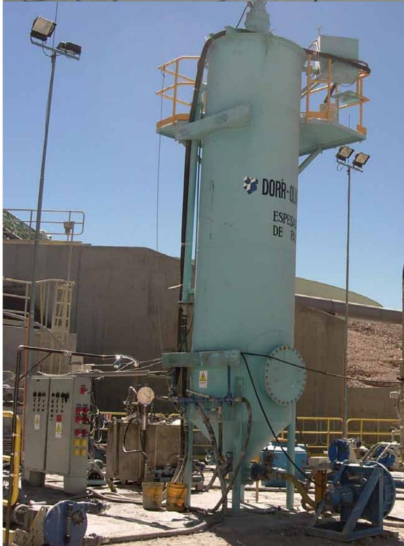
El equipo utilizado fue un espesador piloto de 1,5 m de diámetro y 5 m de altura, similar al de la fotografía.
