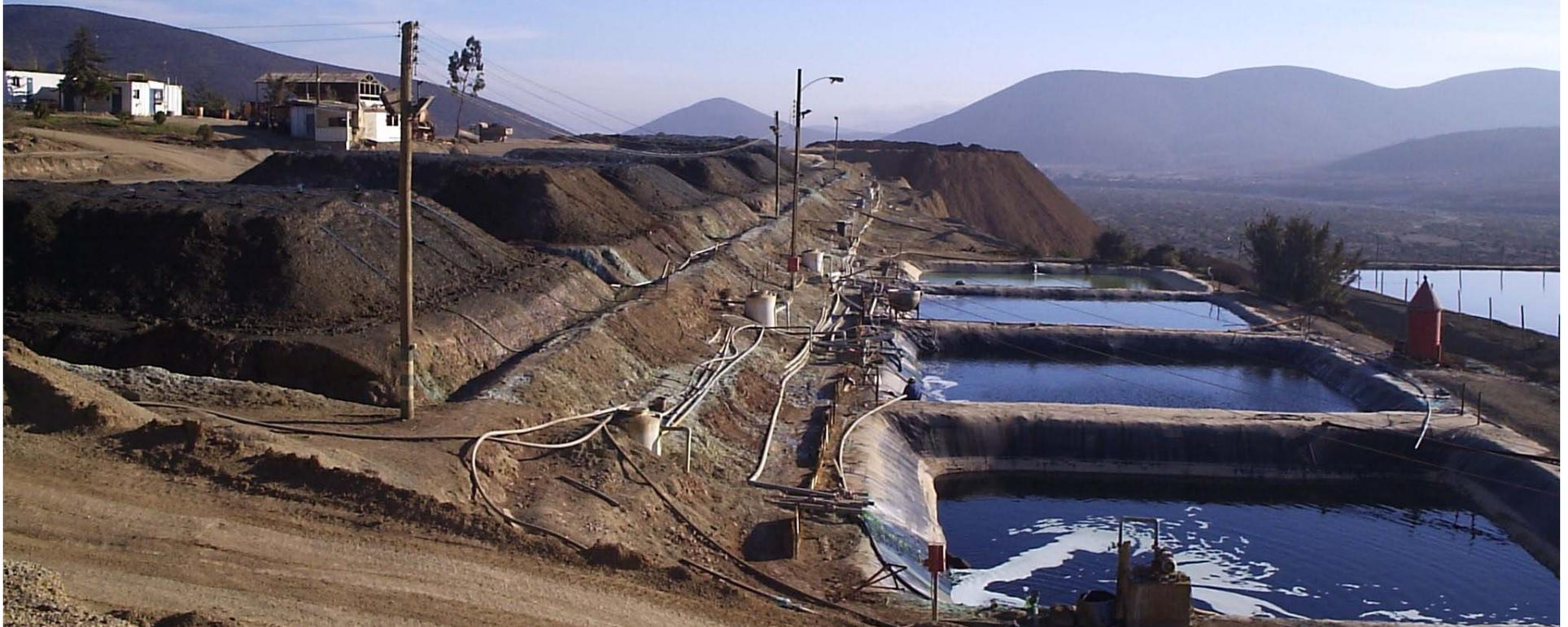
Las soluciones pobres provienen de pilas agotadas y se destinan al riego de pilas mas recientes generando soluciones intermedias que son reenviadas a pilas nuevas para concentrarse y alimentar la precipitación.
