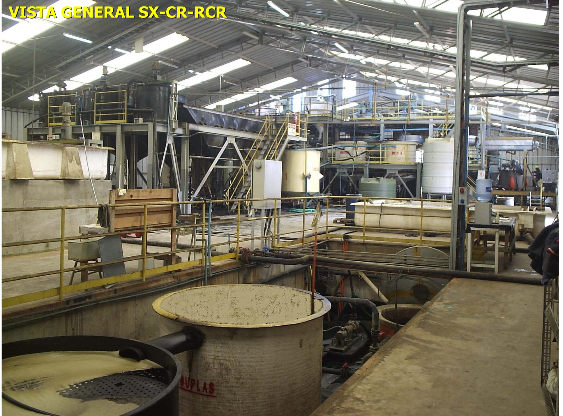
**El sulfato de cobre que se obtiene de la reextracción, es decantado y destinado a un proceso de recristalización en ambiente de temperatura y acidez controlada.**
