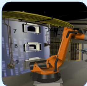
Limpieza Interior Horno de Tostación
