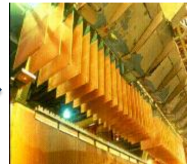
Refinación por Electro-obtención Producto Final 99,99%Cu
